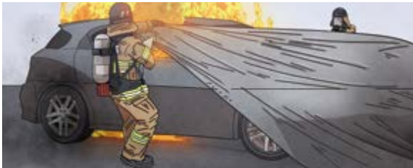
4. 펼쳐진 KEV-cover 양쪽에서 진압대원이 KEV-cover를 잡고 세로방향(9m)으로 전개하여 사고 차량을 덮는다.
